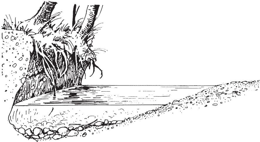
Bild 3.5 Prall- und Gleitufer – die Ufervegetation am Prallufer stabilisiert die Böschungen und sorgt für eine Beschattung des Gewässers
